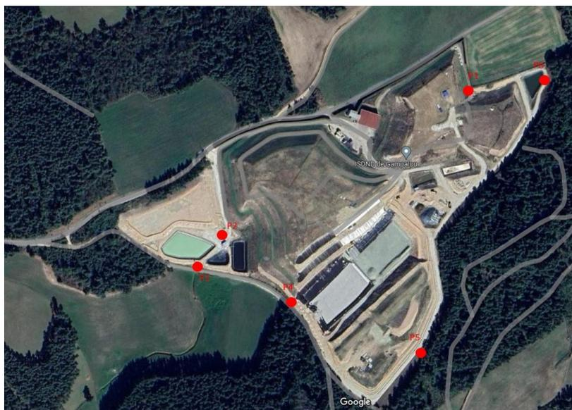
6 piézomètres sont installés à l'intérieur et à l'extérieur du site afin d'établir une analyse des eaux souterraines en période de basses et de hautes eaux.
